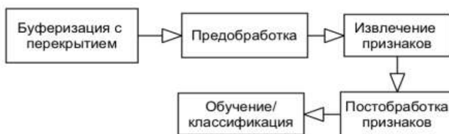
Рис. 1. Схема этапов распознавания аудио событий
