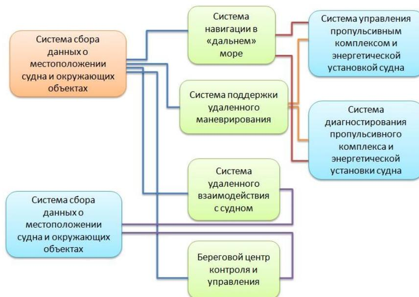
Рис.1. Функциональный состав подсистем обеспечивающих автономное судовождение
